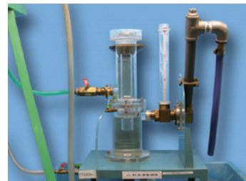
ジオテキスタイルの垂直方向透水試験
