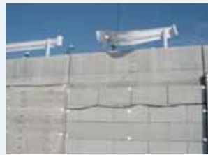
【(独)北海道開発土木研究所・EPS開発機構】 1年間常時微動観測、交通荷重載荷実験、 ガードレール衝突実験など
