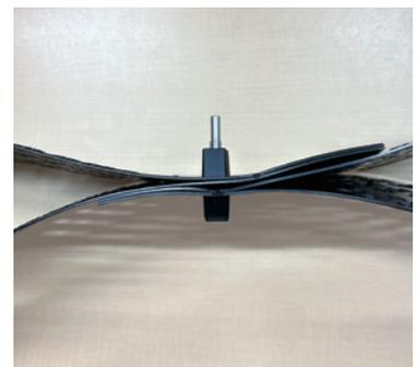
3 セルジョイントのボルトタイプを手で締めるまたは工具にて回転させ締付け接続完了
