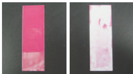
非画線部上のインキ汚れの違い 左：湿し水塗布なし。 右：湿し水塗布。
